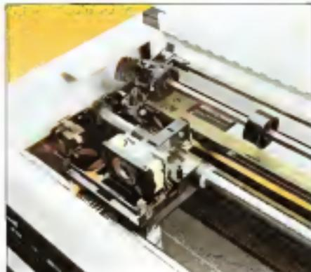
Una vista della ruotina superiore e degli sprocket che servono alla carta nel momento di uscire dallo sprocket aperto.
